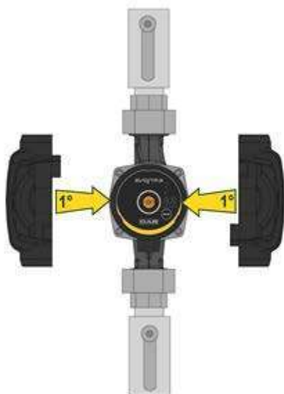
Slika 7: Izolacija ohišja črpalke
