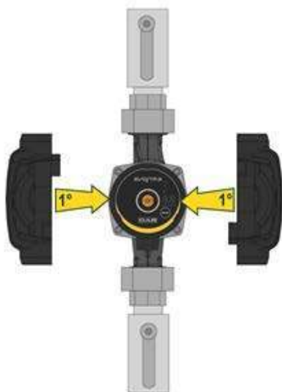
Obrázok 7: Izolácia telesa čerpadla
