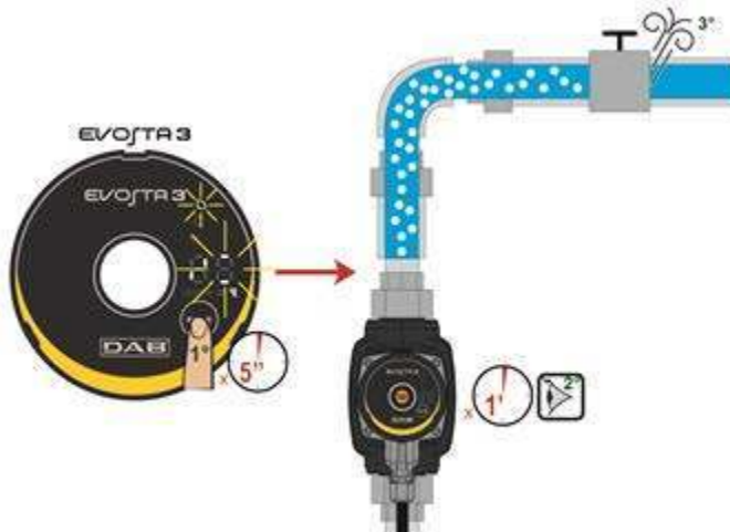
Attēls 9: Sūkņa automātiska gaisa izvadīšana
