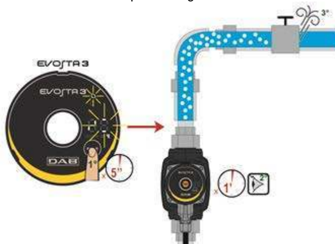
Figura 9: Drenagem automática da bomba
