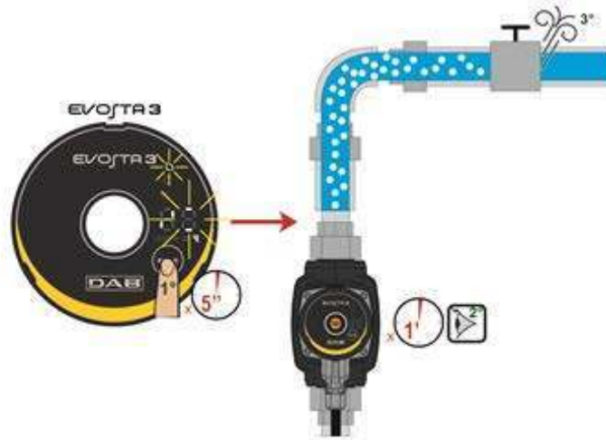
9. ábra: A pumpa automatikus légmentesítése
