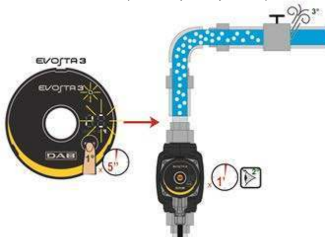
Kuva 9: Pumpun automaattinen ilmaus
