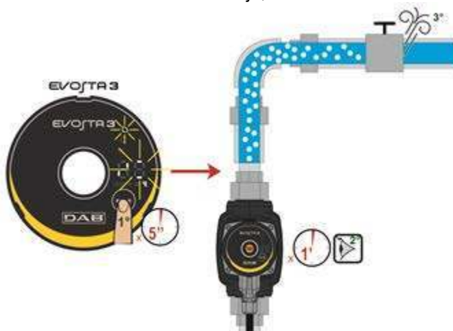
Slika 9: Avtomatska odzračitev črpalke
