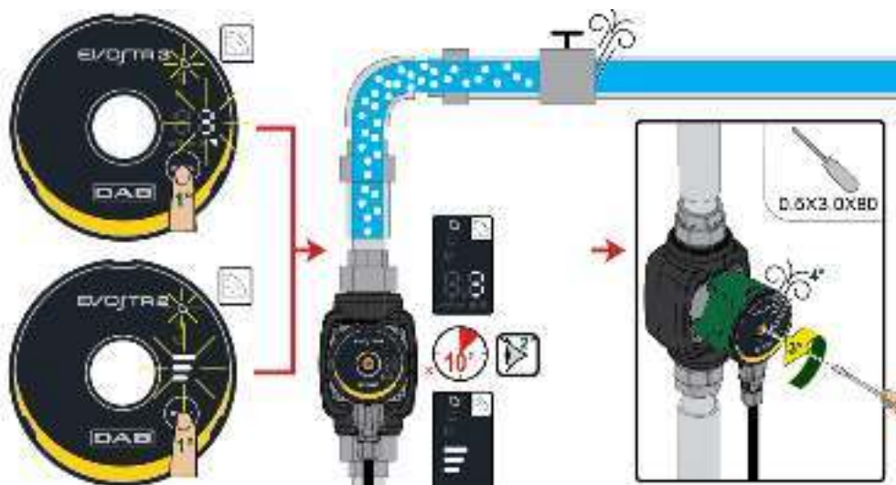
Figura 8: Sfiato della pompa
