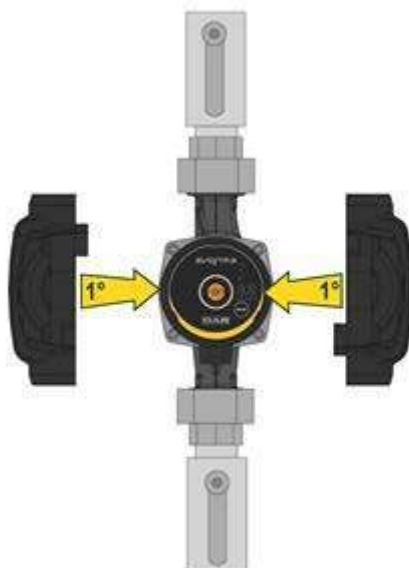
Rysunek 7: Izolacja korpusu pompy
