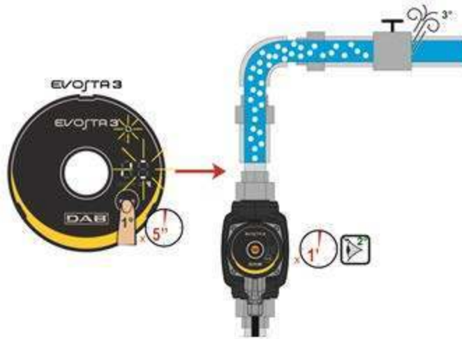
Εικόνα 9: Αυτόματη εξαέρωση της αντλίας
