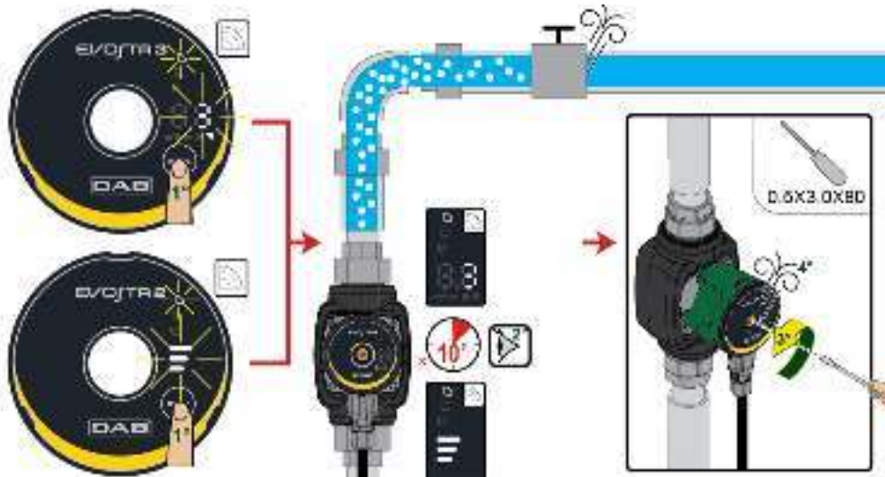
Figura 8: Drenagem da bomba
