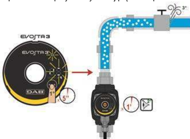
Rysunek 9: Automatyczne odgazowanie pompy
