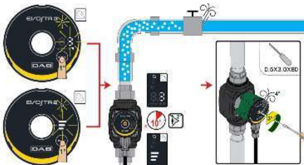
Abb 8: Pumpentlüftung
