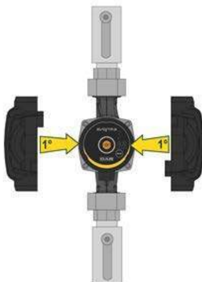
Image 7: Isolation du corps de pompe
