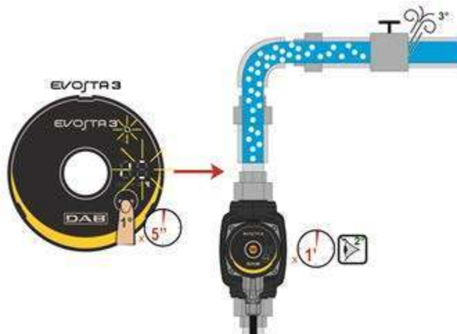
9 pav.: Automatinis oro išleidimas iš siurblio
