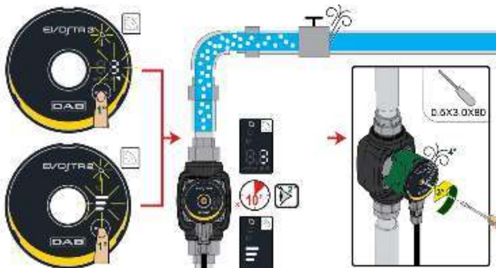
Фигура 8: Обезвъздушаване на помпата
