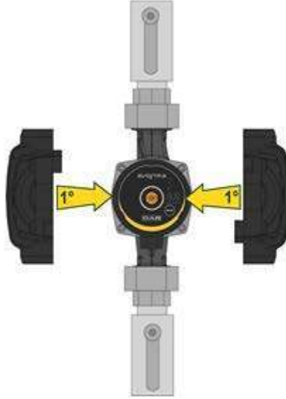
Resim 7: Pompa gövdesinin yalıtımı
