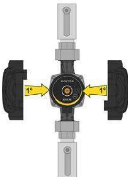
7. ábra: A pumpatest elszigetelése
