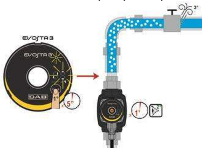
Fig. 9: Automatisk udluftning af pumpe
