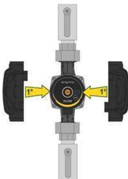
Fig 7: Isolering av pumphuset
