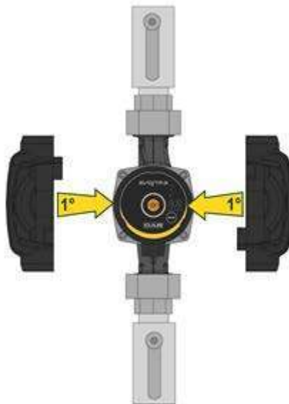
Fig. 7: Isolering af pumpehus
