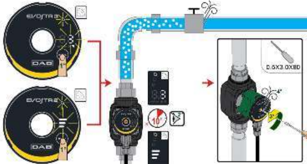
8 pav.: Oro išleidimas iš siurblio
