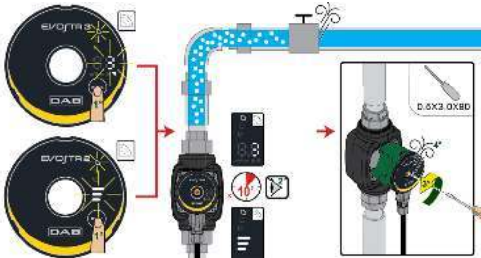
Εικόνα 8: Εξαέρωση της αντλίας
