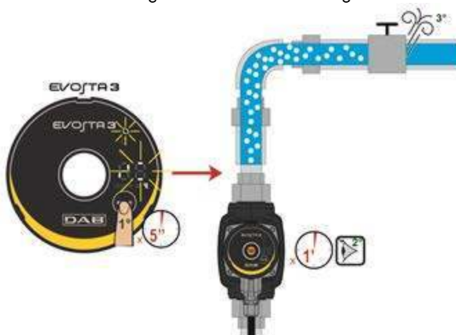
Fig 9: Automatisk avluftning av pumpen
