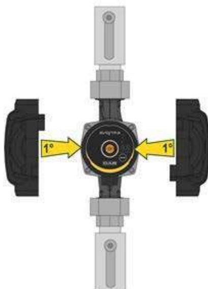
Figura 7: Isolamento do corpo da bomba
