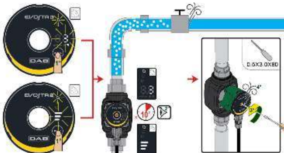
Rysunek 8: Odpowietrzenie pompy
