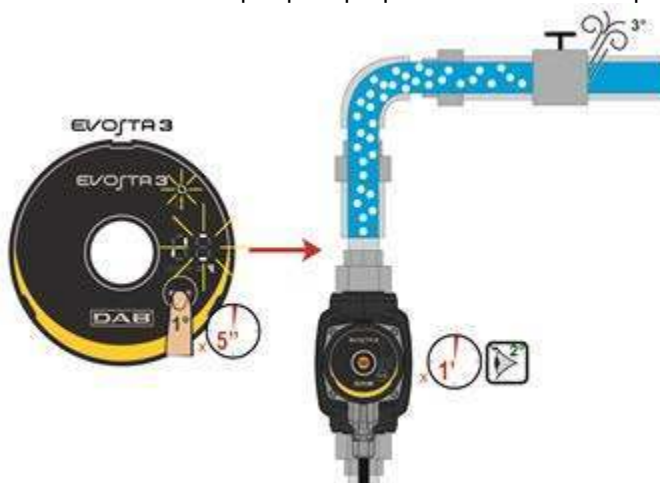
Figura 9: Sfiato automatico della pompa
