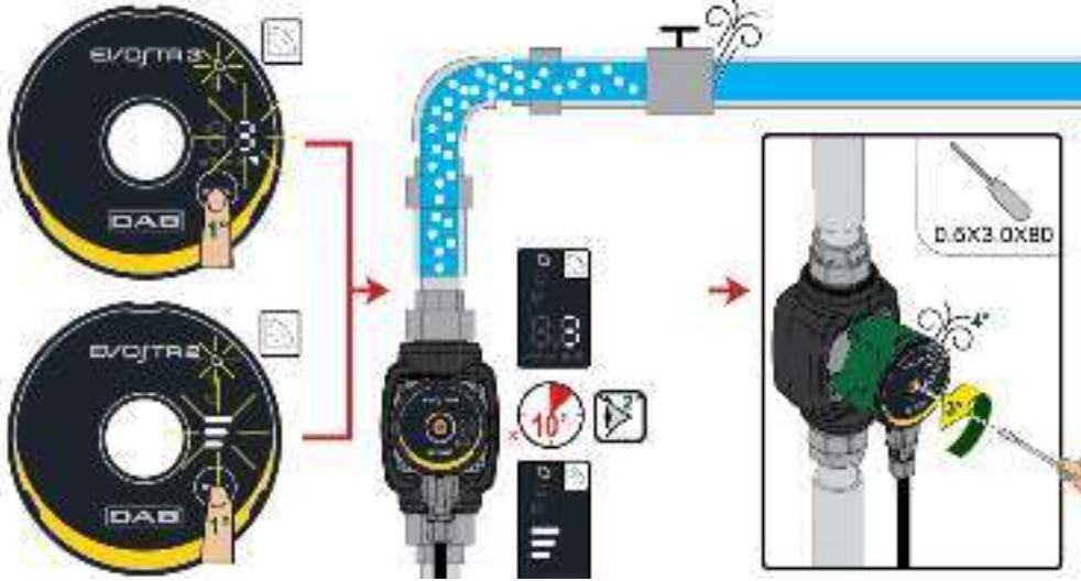
Resim 8: Pompanın havasını boşaltma
