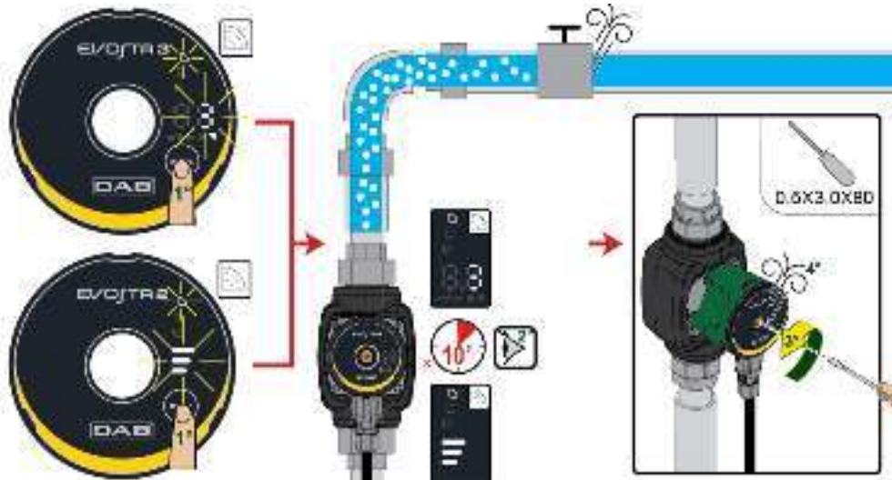
Fig. 8: Udluftning af pumpe
