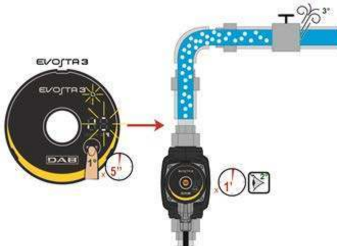
Obrázek 9: Automatické odvzdušnění čerpadla
