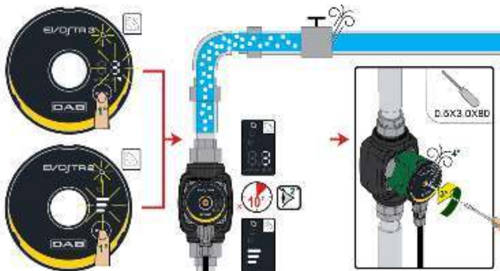
Image 8: Purge de la pompe
