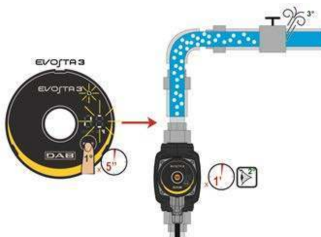
Figura 7: Purga automática de la bomba
