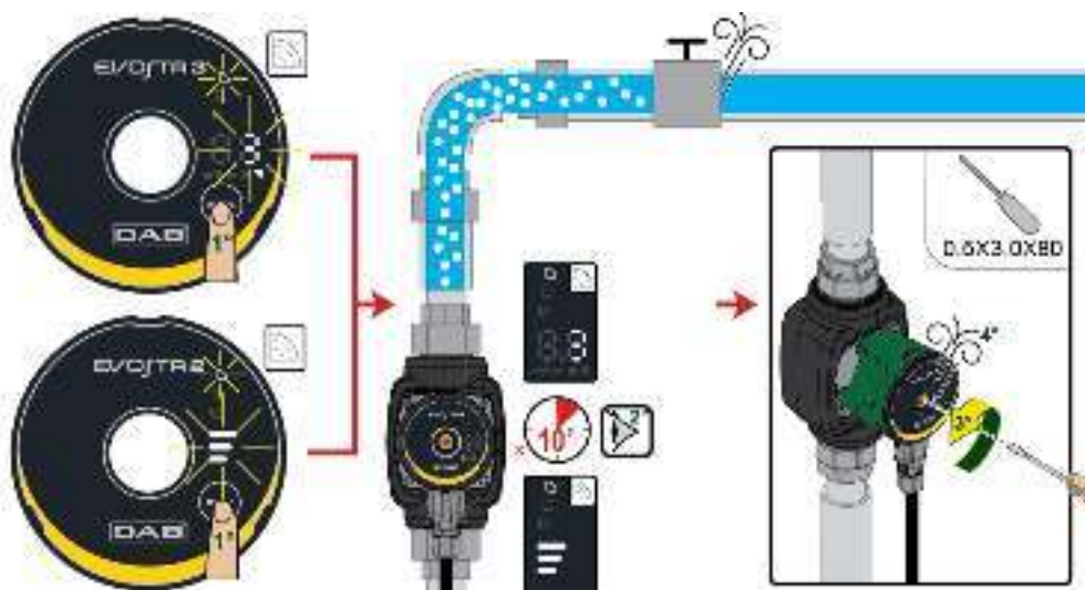
Малюнок 8: Випуск газів з насоса
