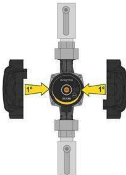
Obrázek 7: Izolace tělesa čerpadla
